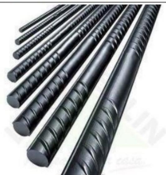
**Informações Gerais:** Com alta resistência, o vergalhão CA-60 é utilizado em estrutura de concreto armado, possui superfície nervurada que garante alta aderência ao concreto. Bitola de 8,0mm, com peso aproximado de 0,395 kg/m, e de 9,5mm, com peso aproximado de 0,558 kg/m. O preço coletado é em kg, sendo comercializado em barra ou em rolo, de acordo com a bitola.
